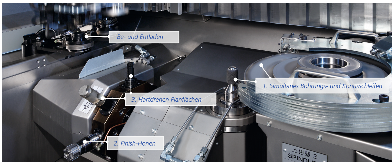
Abbildung 3: BUDERUS BV 235-Kombinationsprozess
