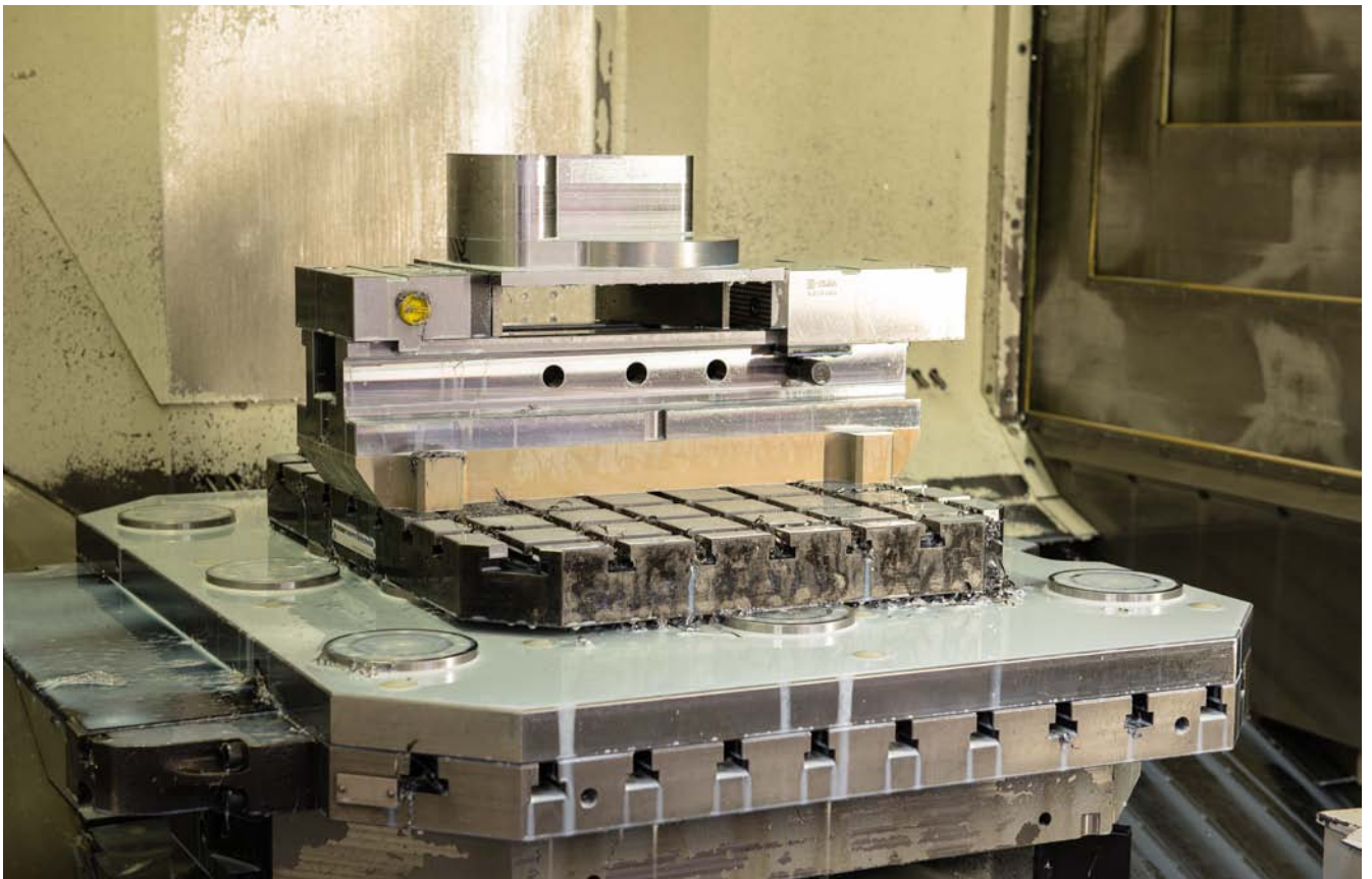
Durch unsere geringe Aufbauhöhe der Spannmodule kann der Spannmittelaufbau flexibel an die jeweilige Bearbeitungshöhe und das Werkstück angepasst werden.
