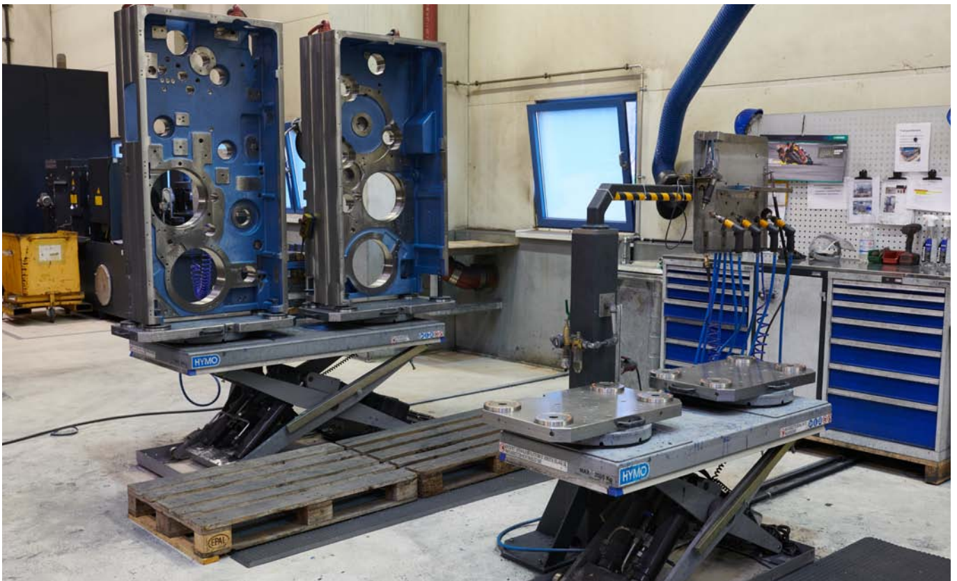
Scheren-Hubtische ausgestattet mit Nullpunktspanntechnik zum Entgraten der Werkstücke. Dadurch wurde der komplette Fertigungsprozess mit dem AMF-Zero-Point-System lückenlos optimiert.
