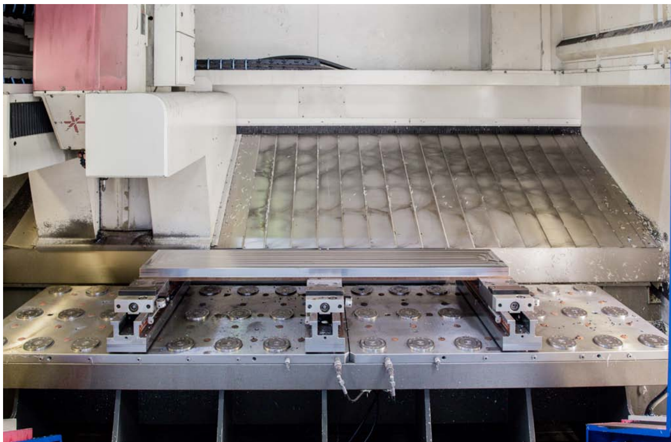
Einfache Ausrichtung mehrerer Spannstücke bei der Bearbeitung von langen Werkstücken.
