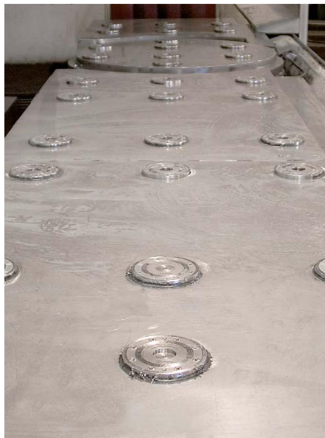
Durch den zylindrischen Aufbau der Spannbolzen sowie der Aufnahme im Spannmodul ist ein Ausgleich von Höhen- und Längentoleranzen auch auf große Distanzen gewährleistet.
