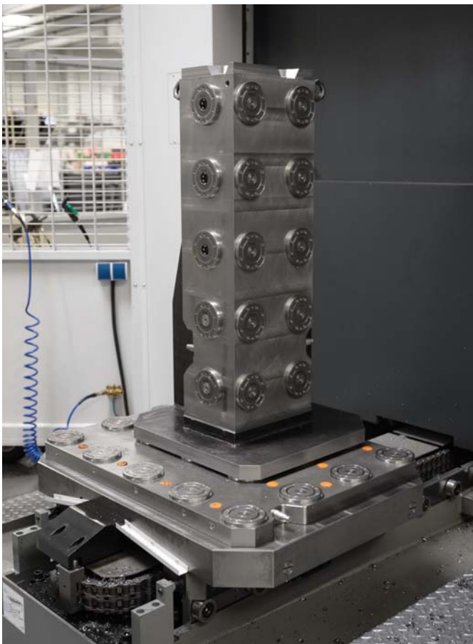
Ideal zugänglich für die 5-Seitenbearbeitung durch unsere modulare Nullpunktspanntechnik.
