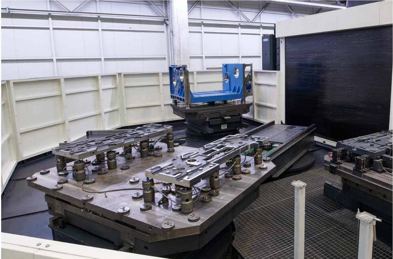
Die Nullpunktspanntürme werden durch einfaches Umsetzen an das jeweilige Werkstück flexibel angepasst. Durch eine Farbkodierung ist eine sichere, wiederholbare Aufspannung gewährleistet.
