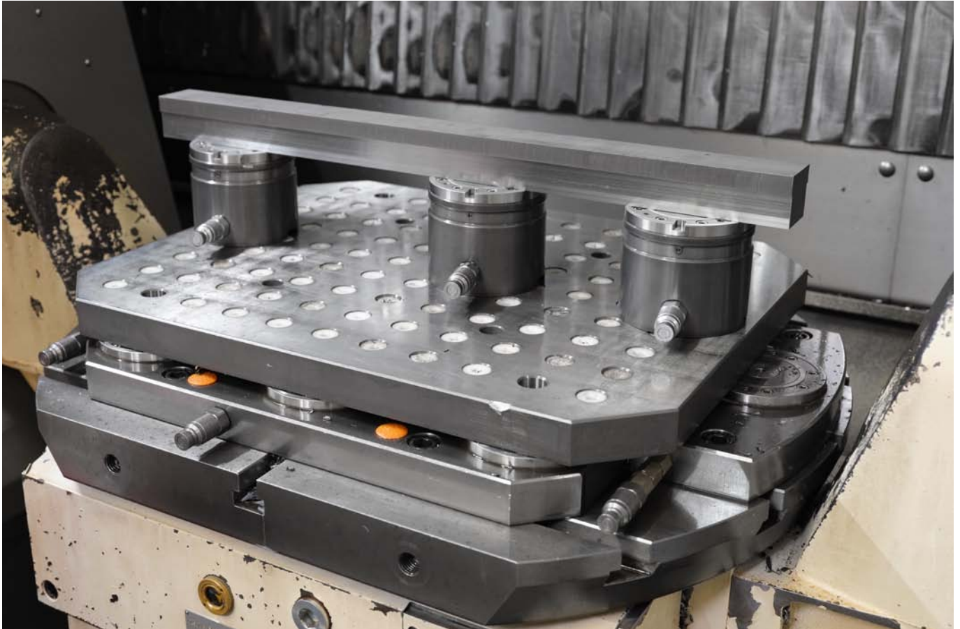
Ideal zugänglich für die 5-Seitenbearbeitung durch unsere modulare Nullpunktspanntechnik.
