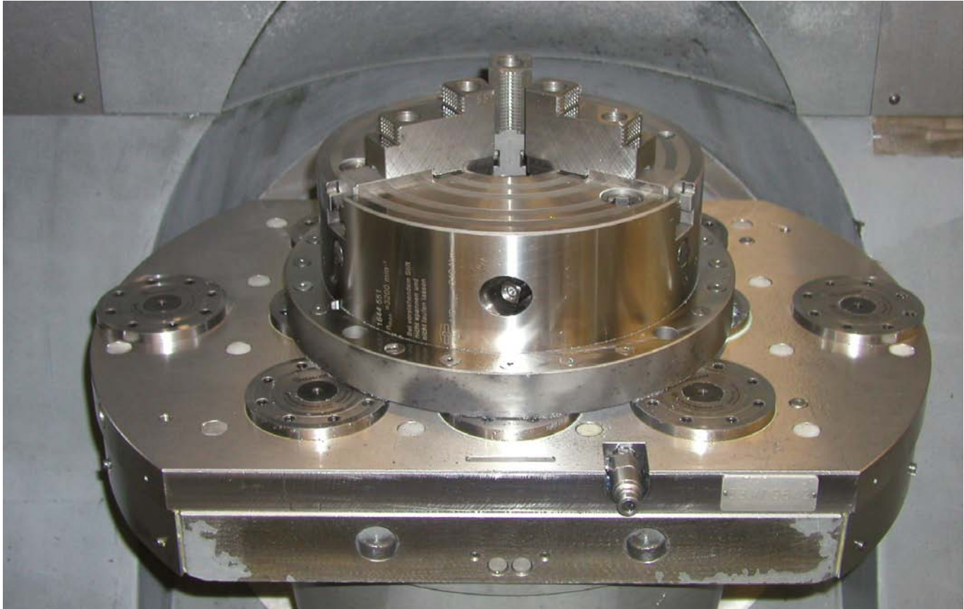
Einfacher Wechsel eines 3-Backenfutters mittels des AMF-Zero-Point-Systems.
