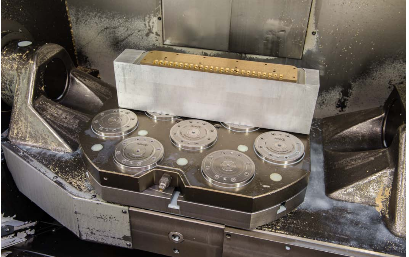
Ob im Standardmodulabstand 200 x 200 mm oder jegliche andere Stichmaße und Anordnungen der Spannmodule, das AMF-Zero-Point-System ist für jede Praxisanforderung anpassbar.
