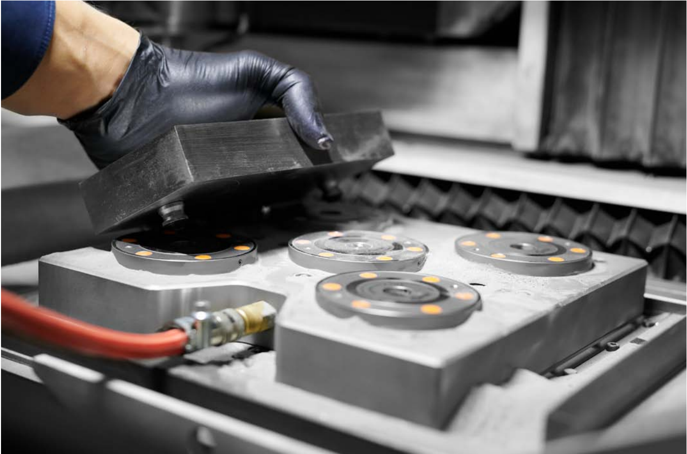
AMF-Zero-Point-Systems in der additiven Fertigung. Die 5-fach-Spannstation ermöglicht das schnelle Wechseln der Substratplatte auf der Hybrid-Maschine (SLS / HSM).
