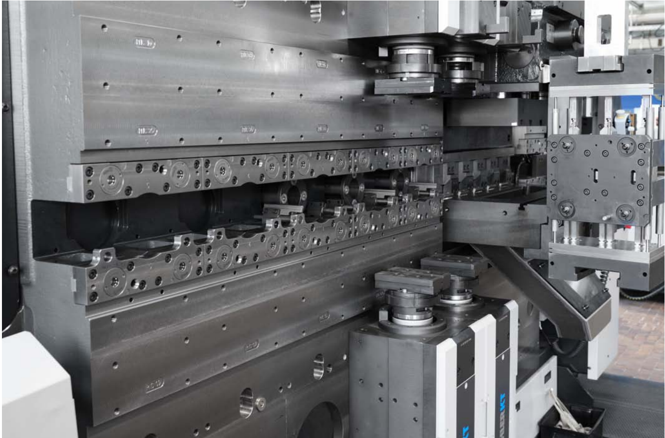
Jede Aufnahme ist mit vier Nullpunktspannmodulen bestückt. Durch die kompakte Bauweise lassen sich die Spannmodule einfach und bündig einschrauben.
