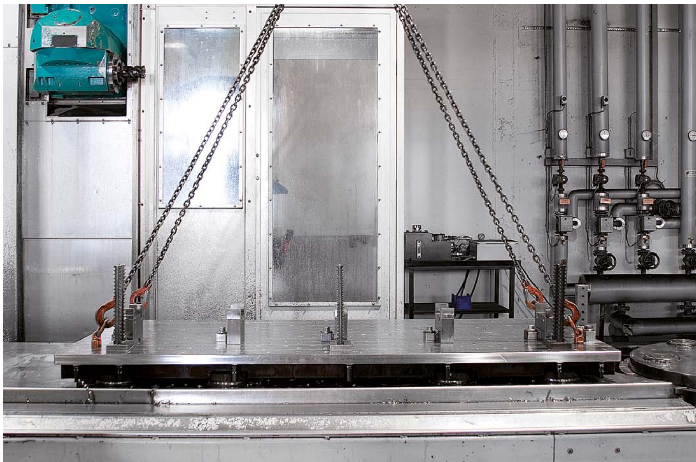
Durch den zylindrischen Aufbau der Spannbolzen sowie der Aufnahme im Spannmodul ist ein Ausgleich von Höhen- und Längentoleranzen auch auf große Distanzen gewährleistet.
