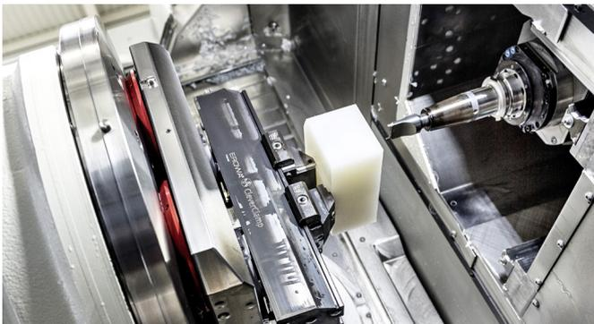
Der Einsatz von EROWA Spannsystemen garantiert Prozesssicherheit. Das Spannsystem bildet die einheitliche Schnittstelle für alle Maschinen im Fertigungsprozess und sorgt für immer gleiche Voraussetzungen. Genau damit wird die automatisierte Beladung von Einzelteilen und Kleinserien erst wirtschaftlich.
