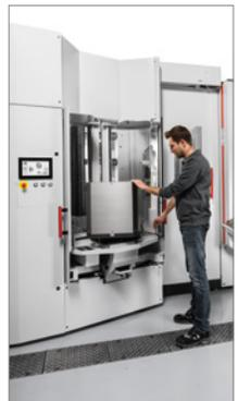
HS flex mit zwei Palettenspeichermodulem und Rüstplatz, adaptiert an ein Bearbeitungszentrum C 42 U.
