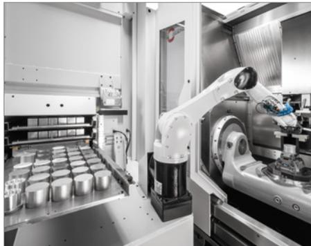
Greifer eines Robotersystems RS 05-2
