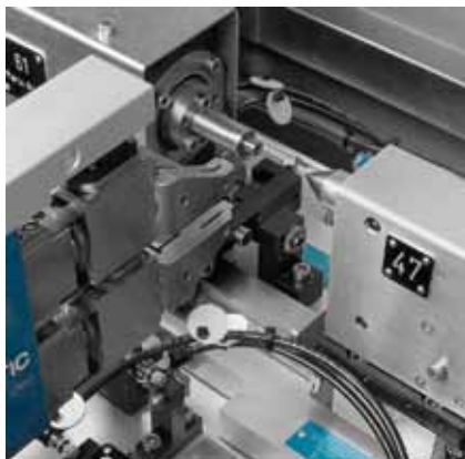
Station 4: Durchmesser nachmessen
