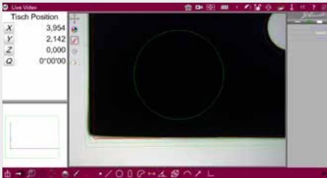
Optischer "gut/schlecht"-Vergleich mit frei generierbarem Toleranzband zur aktiven Unterstützung bei der Bedienung.
