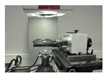
**MV 600 in Sonderbauform** mit seitlich versetzter Hubsäule sowie einer manuellen Drehachse SK50, ermöglicht die Messung von Werkzeugen mit großen Durchmessern. Natürlich ist auch optional ein Glastisch mit SK50 Aufnahme im Lieferumfang enthalten.
