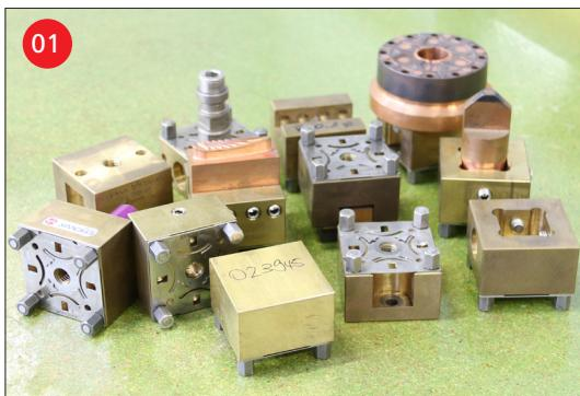
Prüfen Sie den allgemeinen Zustand der Elektrodenhalter auf Beschädigungen am Spannkörper (Gewinde, Auflageflächen der Rohlinge), der Stützfüsse und der Zentrierplatten (ausgeleerte Stanzung).
