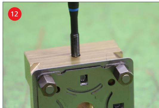
Bei Verwendung von EWIS™ Chips zur automatischen Haltererkennung ist auch das Gewinde auf der Referenzseite anzubringen. (Chip ER- 094168).
