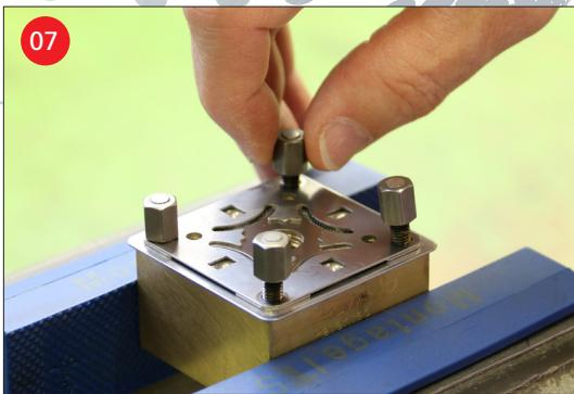
Montieren Sie die Dichtplatte (mit neuen oder bestehenden Zentrierplatten und Stützfüssen) auf den bestehenden Halter.
