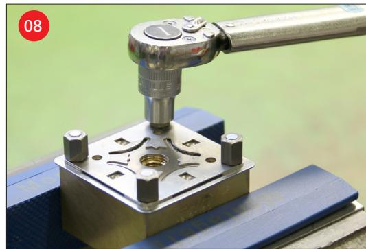
**ACHTUNG:** Die Stützfüsse müssen zwingend mit einem Drehmomentschlüssel (z.B. ER-011600) festgezogen werden. Drehmoment: 8 Nm.
