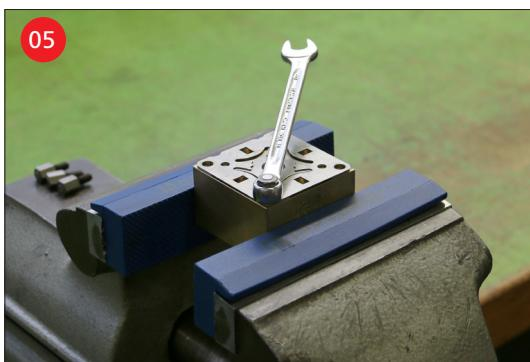
Lösen Sie die Zentrierplatten vom Halter indem die Stützfüße (SW 8) abgeschraubt werden. Reinigen Sie die Teile welche weiter verwendet werden.
