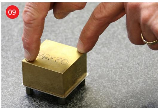
Stellen Sie sicher, dass die Stützfüsse eine plane Ebene bilden.
