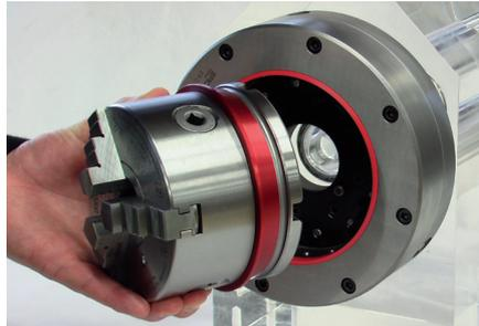
Ein Dreibackenfutter wird eingesetzt. Sowohl Plan- wie auch Rundlauf werden auf 0.002 mm genau repetiert.
