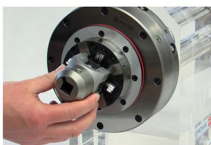
Jegliche EROWA ITS Systemträger werden sicher, schnell und präzis gespannt.
