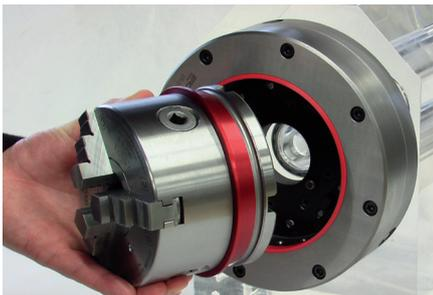
Das Basis Spannfutter wird geöffnet und das Dreibackenfutter wird entnommen.
