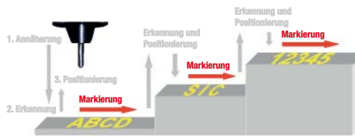
Autosensing: integrierter Sensor für einen konstanten Abstand zwischen Nadel und Werkstück
