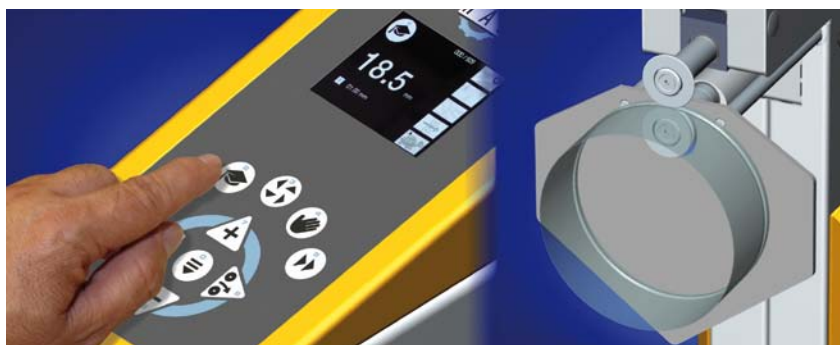
Teachen der Maschine beim Fertigen des ersten Teils
