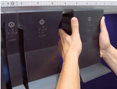
Die UpDownBend spannt die Werkzeuge der Oberwange und der Biegewange automatisch
