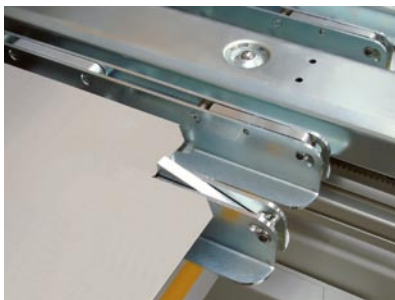
Sonderanschlag mit einzeln hochstellbaren Anschlagfingern
