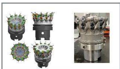
Seco Tools bearbeitet die Werkzeuge nach dem additiven Fertigungsprozess nach, sodass sie ihre endgültige Form und Funktion erhalten. © Seco Tools
